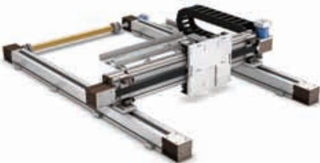
> Zweiachs-System X/Y mit Zahnriemen und / oder Zahnstangenantrieb in Gantry-Bauweise bildet die Basis für die Handhabung auf einer horizontalen Ebene. Die kundenseitige Adaption erfolgt auf dem Schlitten der Y-Achse. Dieser kann kundenspezifisch abgestimmt werden. Laufrollen- oder Profilschienenführungen garantieren hohe Dynamiken und eine hohe Belastbarkeit.
