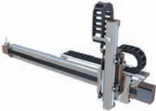
> Zweiachs-System Y/Z mit Zahnriemen und / oder Zahnstangenantrieb. Die kundenseitige Adaption erfolgt direkt oder mittels einer Verbindungsplatte an der Stirnseite der Z-Achse. Laufrollen- oder Profilschienenführungen garantieren hohe Dynamiken und eine hohe Belastbarkeit.
