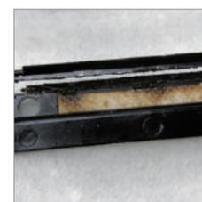
Rückstände getrockneter Schmierstoffes auf einer der Testschienen, unterer Schmierpad beginnt sich leicht zu verformen
