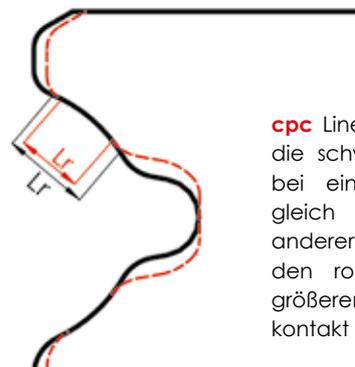
**cpc** Linearführungen (siehe die schwarze Linie) haben bei einem Vergleich mit gleich breiten Schienen anderer Fabrikaten (siehe den roten Faden) einen größeren Oberflächenkontakt
