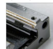
Obere Schmierpads in gutem Zustand. Kein Schmierstoffausstrag auf die Schiene.
