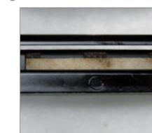
Untere Schmierpads in gutem Zustand. Schmierstoffversorgung gewährleistet.
