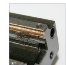
Rückstände getrockneter Schmierstoffes bei 2 der 8 Laufwagen, oberer Schmierpad beginnt sich leicht zu verformen
